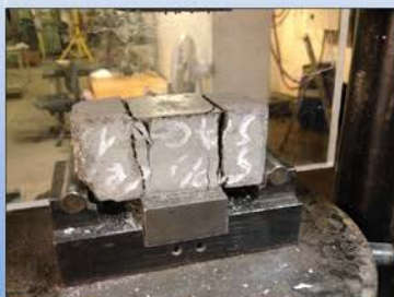
Billede 1: Trykprøvning af mørtelprøven
