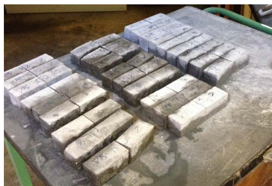
Figur 5.5: Mørtelprøver efter træktest
