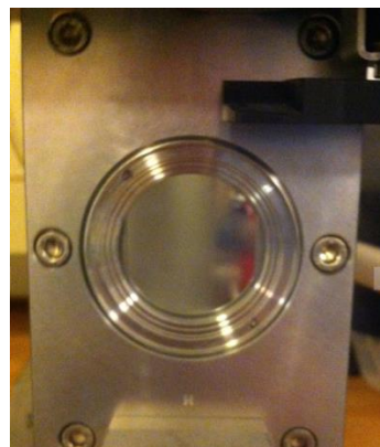
Figur 35. - Der hvor asken bliver blæst igennem og målt
