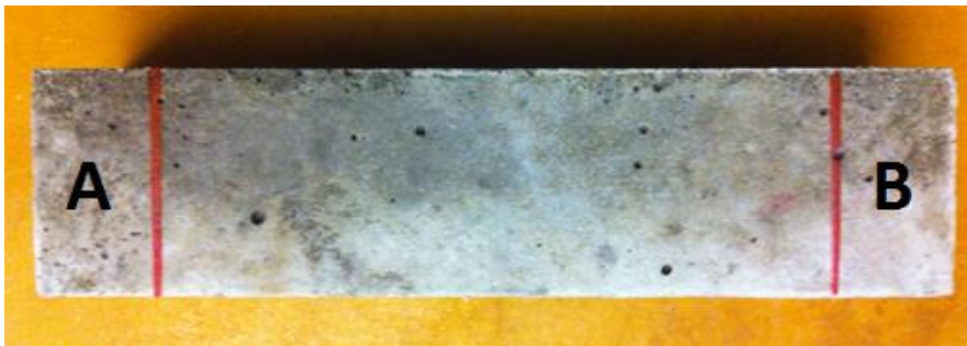
Figur 23 – Mørtelprisme med markerings streg til trykprøve
