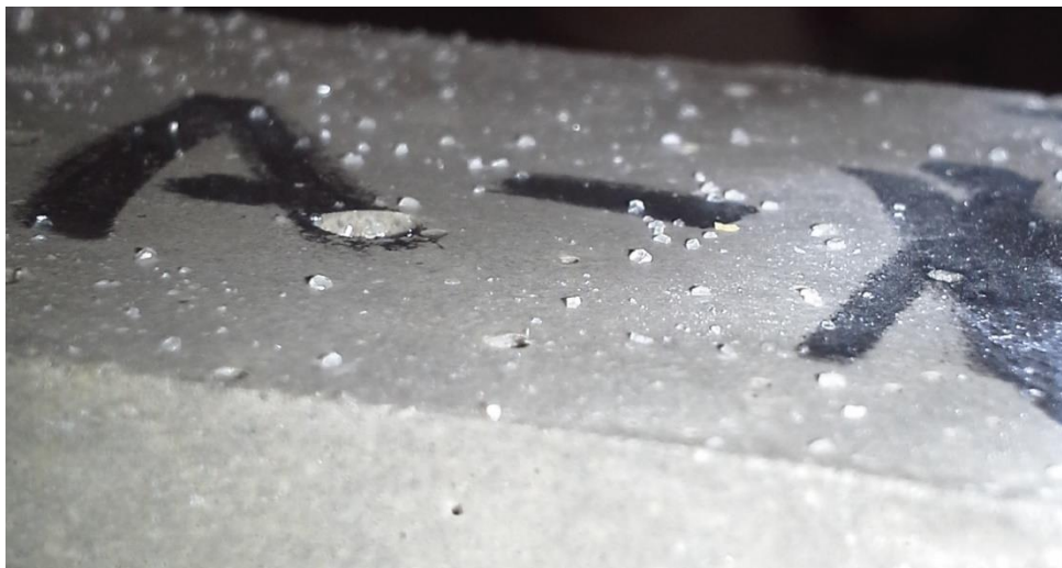
Figur 9 - Billede af udkrystalliseret salt, på overflade af mørtelprøve
