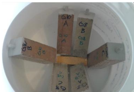
Figur 3.22: Mørtelprøver står i saltvand – fuld dækket
