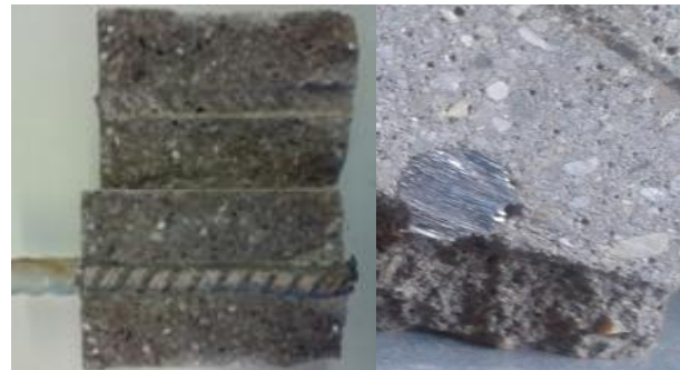
Figur 4.16: Resultat af askeprøven (overflade & tværsnit)
