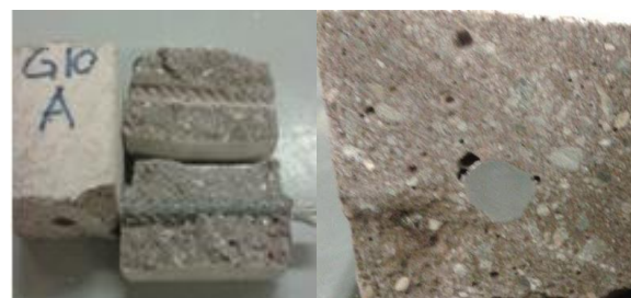
Figur 4.12: Resultat af askeprøven (overflade & tværsnit)
