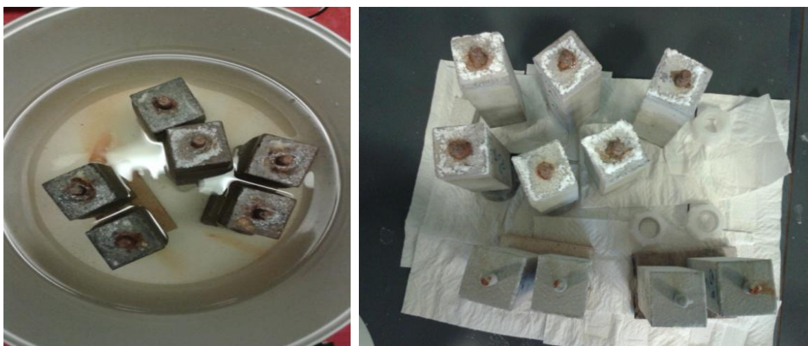
Figur 4.20: Korrosion på armeringsstangen som stikker ud af betonen
