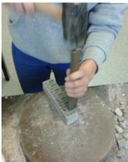
Figur 3.31: Mørtelprøven deles op i 8 dele
