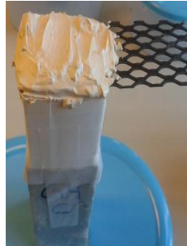
Figur 3.28: Net-elektrode placeres i leret
