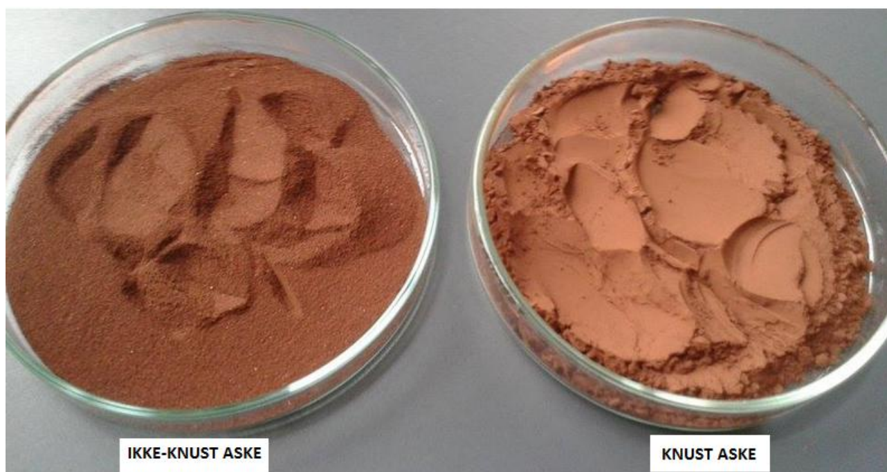
Figur 8.5: Ikke-knust aske og knust aske fra Avedøre I/S
