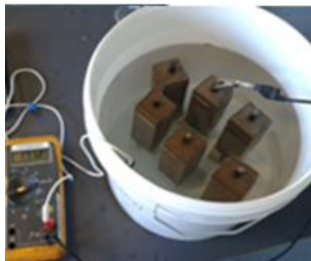
Figur 3.20: Potentialemåling, hvor mørtelprøverne står i saltvand
