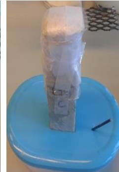
Figur 3.29: Mørtelprøve klistres til med folie
