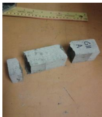
Figur 3.17: Mørtelprøve efter et tryk i hver ende
