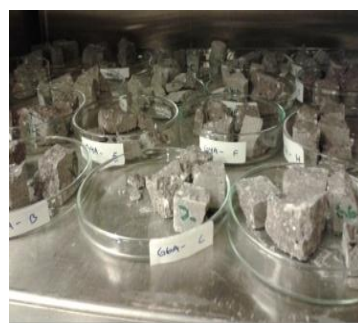
Figur 3.31: Mørtel stykkerne sættes over i varmeovn på 105 grader
