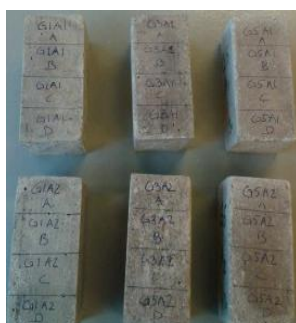
Figur 3.38: Mørtelprøve deles op i 4 dele
