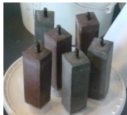
Figur 3.21: Mørtelprøverne står til tørre
