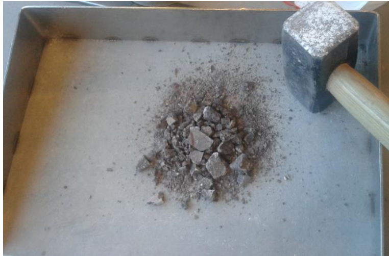
Figur 8.13: Mørtelprøve knust med hammer
