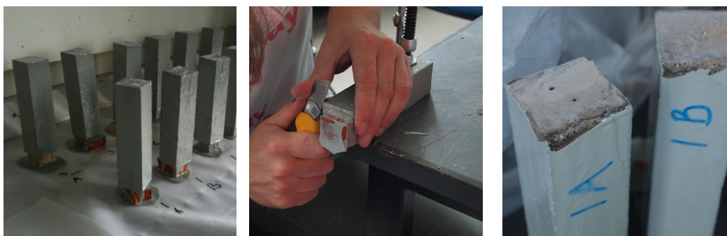
(a) Prøvernes opstilling imens malingen tørrede (b) Aluminiumstapen kunne fjernes med en hobbykniv (c) I forbindelse med fjernelsen af tapen afskallede malingen på nogen af prøverne.
