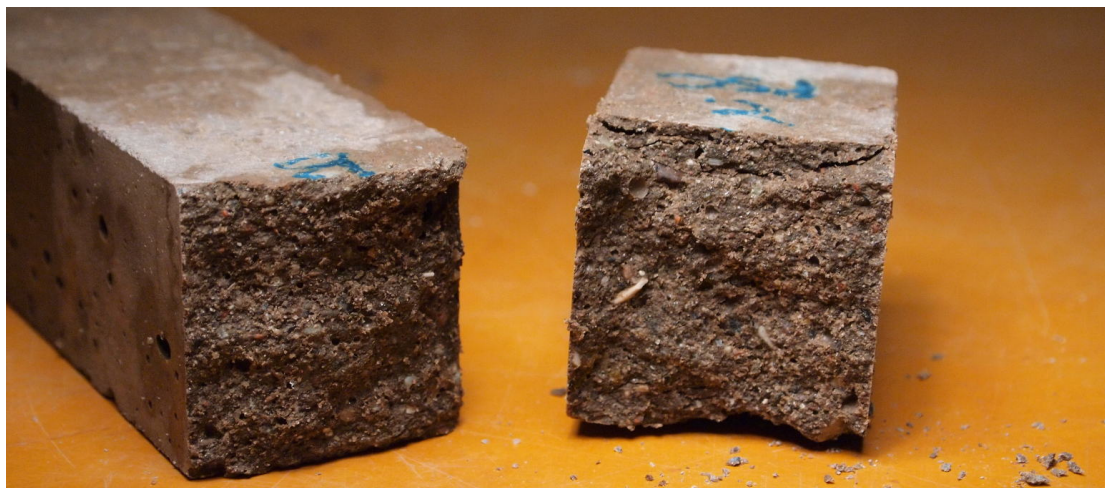
Figur H.4: Prøve 2B (5%S) efter brud.
