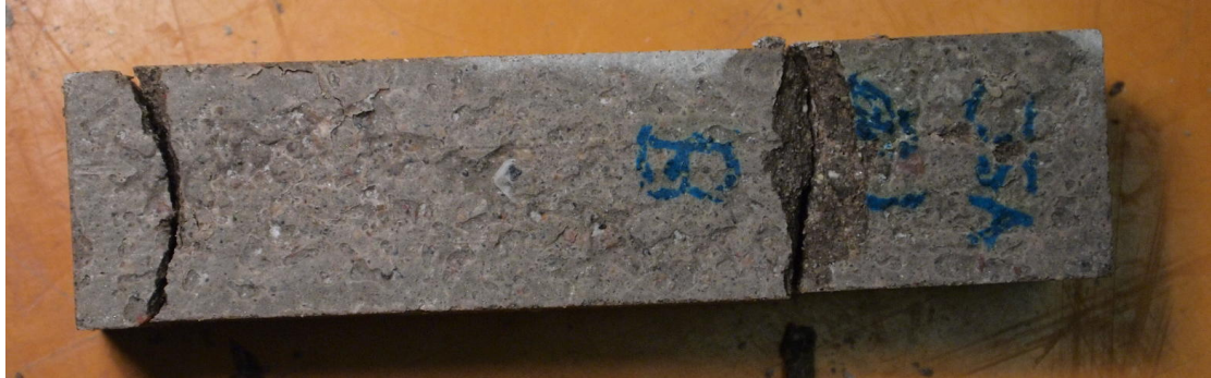
Figur H.2: Prøve 1B (REF) efter brud. Begge ender knækket
