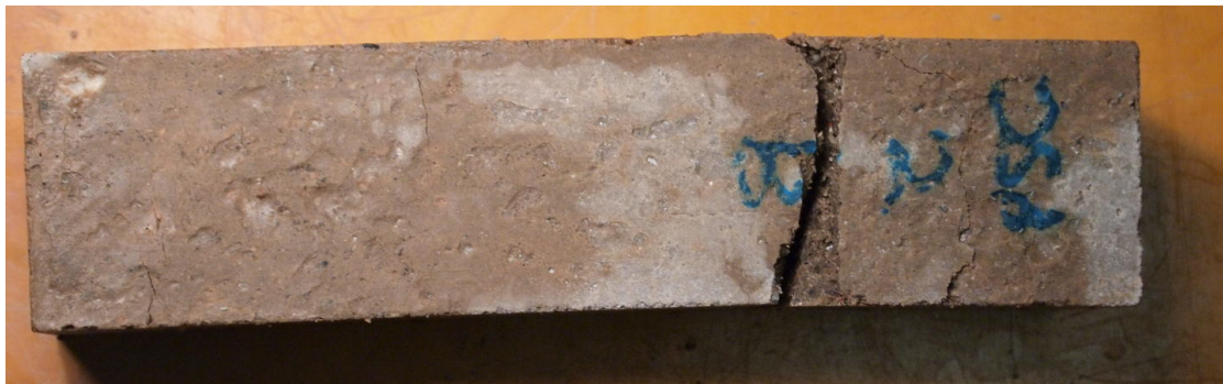
Figur H.3: Prøve 2B (5%S) efter brud. Den ene ende knak af sig selv. Den anden holdt stadig sammen
