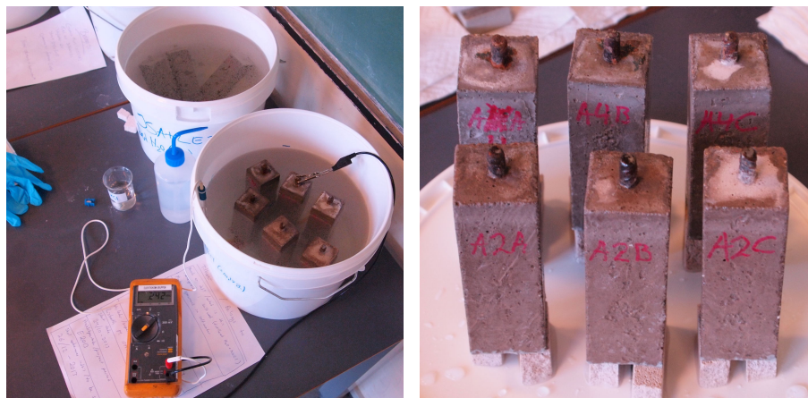
(a) Armeringsprøver i saltvand, under potentialemåling
