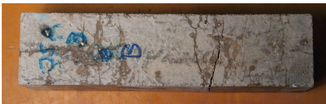
Figur H.6: Prøve 3B (10%C) efter brud. Begge ender holdt sammen. Fraktur ses tydeligt i højre side
