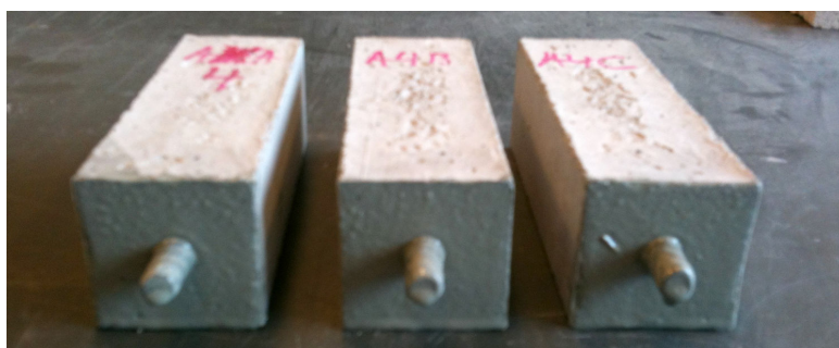
Figur 3.8: Prøver med armeringsstål, belagt med epoxy i enderne
