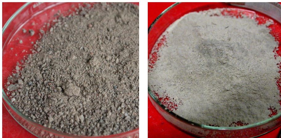
(a) Mørtelprøver efter knusning med hammer (b) Mørtelprøve efter knusning i ringknuser
