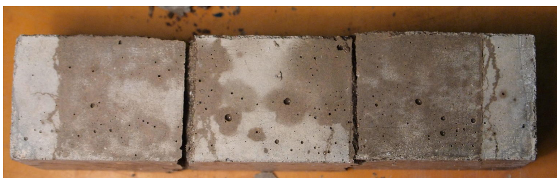
Figur H.5: Prøve 3A (10%C) efter brud. Begge ender knækket
