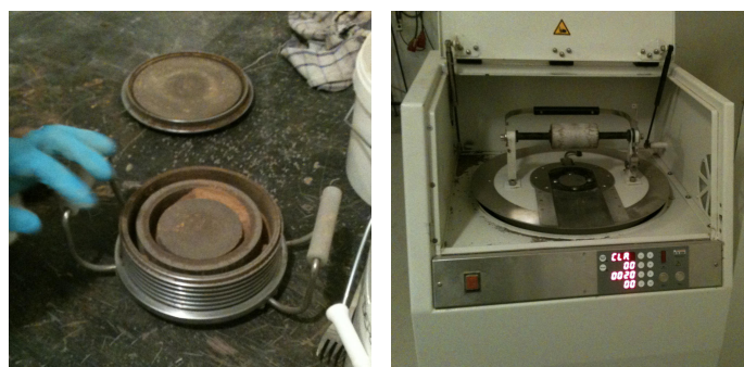
(a) Ringknuseren blev halvt fyldt med aske (b) Herefter blev asken knust i 20 sekunder
