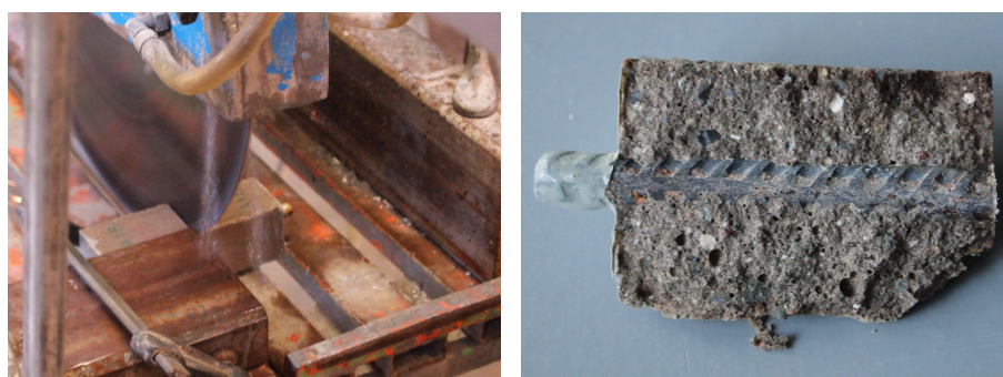
(a) Vådskæring af prøver med indstøbt armeringsstål
