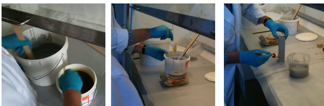
(a) Omrøring af maling og hærdere
