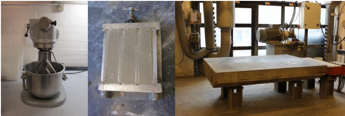
Figur 5: Billede af mixer (til venstre), form (i midten) samt stort vibratorbord (til højre)
