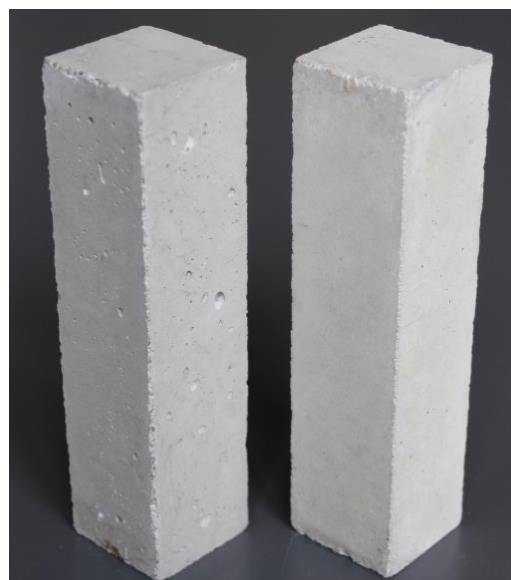
Figur 20: Mørtelprøve støbt fra recept B (til venstre) og recept A (til højre)
