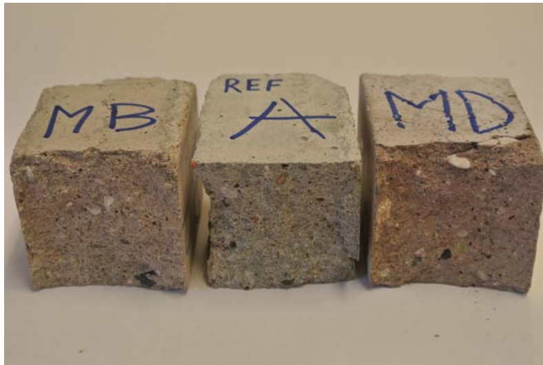
Billede 4-12 Mørtelprøver støbt med knust aske samt referencen
