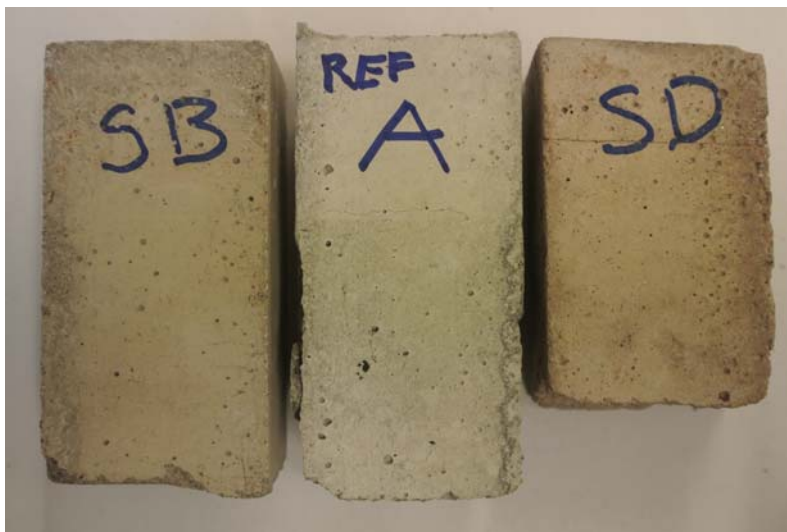
Billede 4-11 Mørtelprøver støbt med syrevasket aske samt referencen
