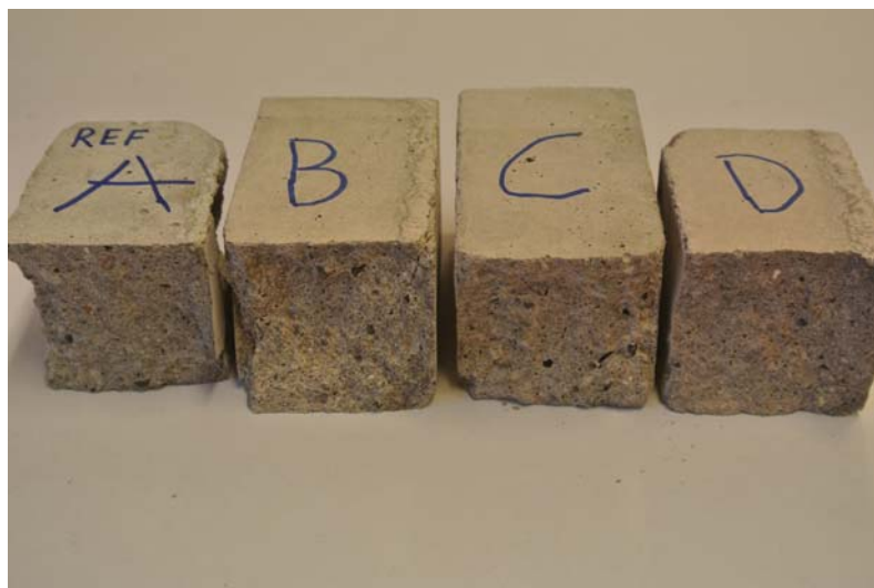
Billede 4-10 Mørtelprøverne støbt med ubehandlet aske samt reference
