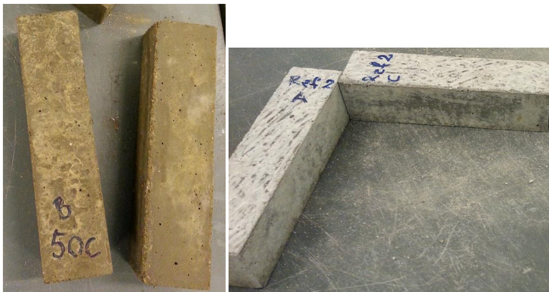
Figur 25: Her ses mørtelprøverne 50C og Ref 2 umiddelbart efter de er taget ud af støbformen. Der er markant farveforskel på prøver med og uden flyveaske tilsat.
