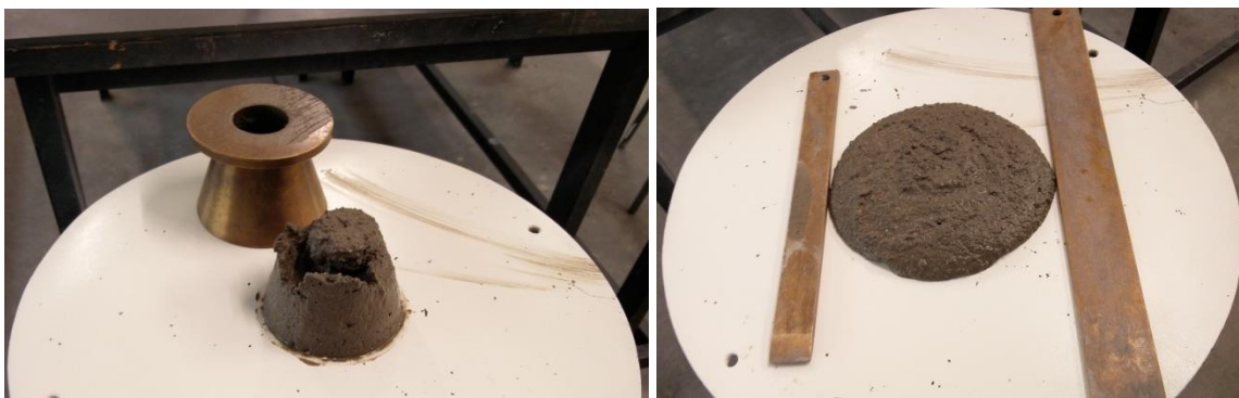
Figur 5: Her ses udførelsen af hhv. sæt- og flydemålsprøven på mørtelprøve Ref s2.
