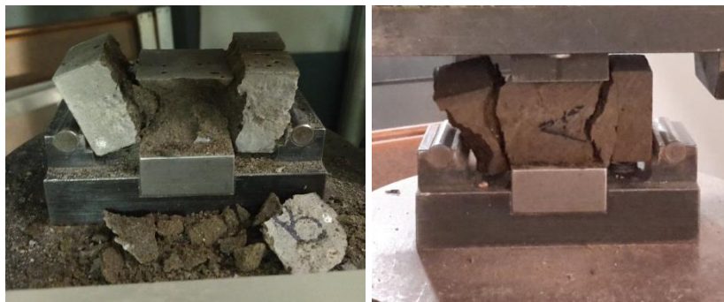
Figur 12: To mørtelprøver efter trykstyrkeprøvning. Til venstre ses 30C 3 B, til højre 50C s4 A. Bemærk hvordan prøven til venstre er sprængt 'fra hinanden', modsat den til højre.
