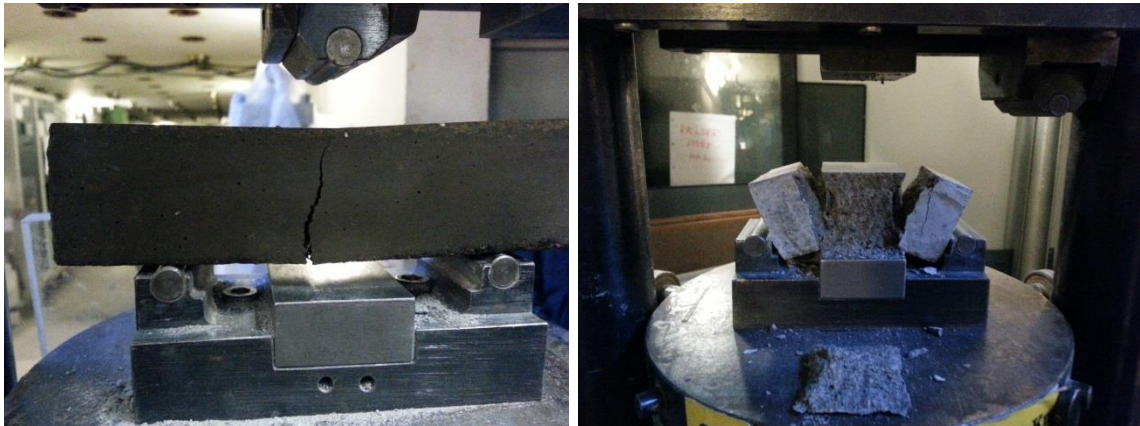
Figur 6: Opstilling i prøvemaskinen umiddelbart efter bestemmelse af hhv. bøjetrækstyrke og trykstyrke. Bemærk de forskellige indsætter for oven.
