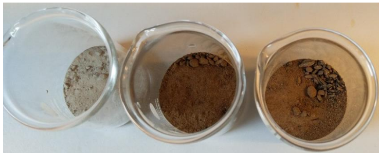
Figur 18: Det kan her ses hvordan flyveasken, modsat cementen, klumper.
