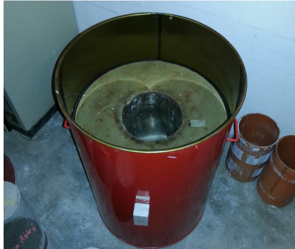
Figur 8: Tønde brugt til måling af varmedviklingen.
