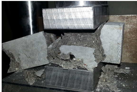
Figur 11: Prøve der smuldrede under styrkeprøvningen.
