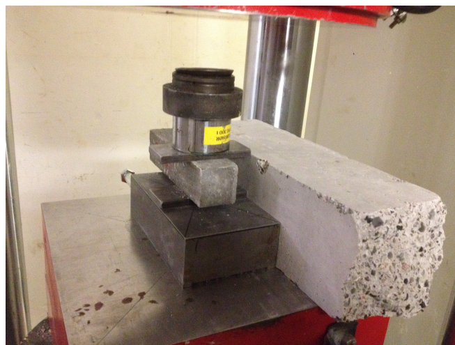
Figur 3.4: Opstilling til trykprøvning i Toni 300
