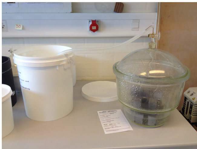
Figur 3.9: Undertryk medfører, at der suges vand ind i ekssikkatoren
