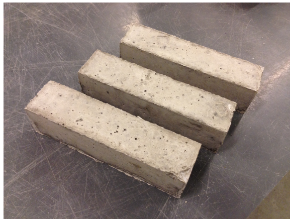
(b) Færdigstøbte prismer inden de lægges i vand
