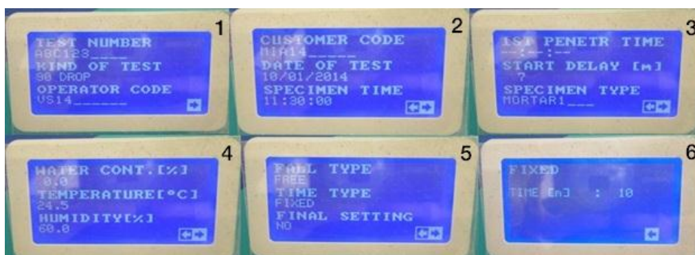
FIGUR 4. BILLEDEINSTRUKTION AF TESTINDSTILLINGER FOR TEST TYPE "90 DROP".
