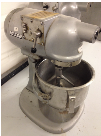
Figur 3.2: Hobart-blandemaskine til blanding af mørtel
