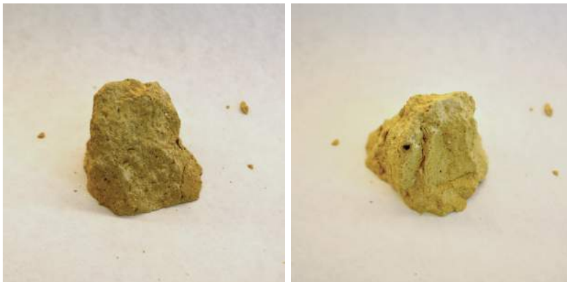
Figur IV.10.: Billedet illustrerer brudrester fra en kubeproeve med 10 % glasuld. Udover farveforskellen ses synligere porer og en sort plamage der tager for at glasuldets organiske materiale er afbrændt her
