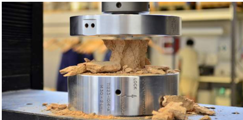
Figur 4.4.9.: Billedet illustrerer den indre revnedannelse, på samme prøve med 0 % glasuld, hvor timeglasformen tydeligt kommer til udtryk. Lignende illustrationer kan findes i IV. Appendiks .
