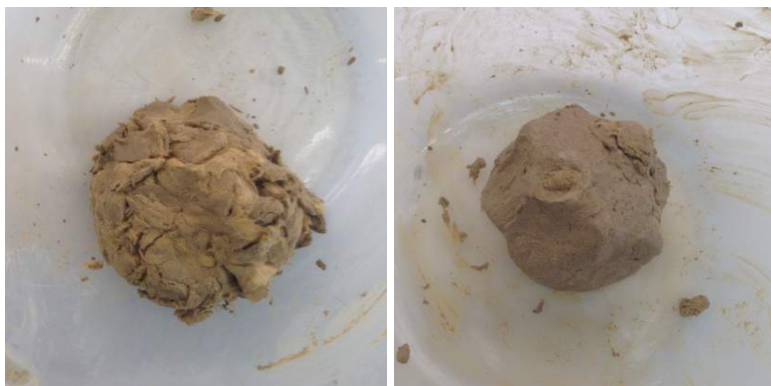
Figur II.2.: Blandingsmassen bliver, ved æltning, mere og mere ensartet, som det fremgår af billederne. Billedet til højre er endnu ikke æltet tilstrækkeligt, til at opnå den ønskede ensartede masse.
