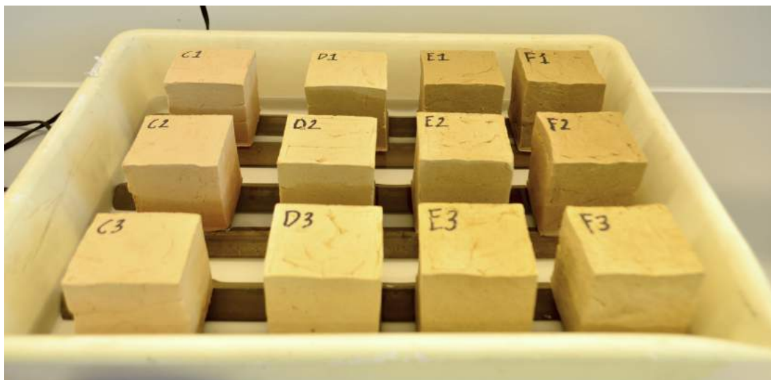
Figur V.1.: Kapillarsugningsforsøg, hvoraf opsugningsmængden kan ses direkte på prøverne. Hvert prøvesæt (1, 2, 3) er igangsat løbende.
