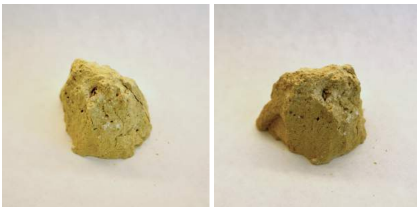
Figur IV.11.: Billedet illustrerer brudrester fra en kubeproeve med 15 % glasuld, hvorfra der kan observeres øgede porrevidder.
