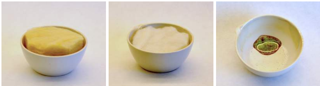
Figur 4.1.2.: Glasuld i tre forskellige stadier, fra venstre; 1) uopvarmet 2) opvarmet til 550 °C, 3) opvarmet til 950 °C.
