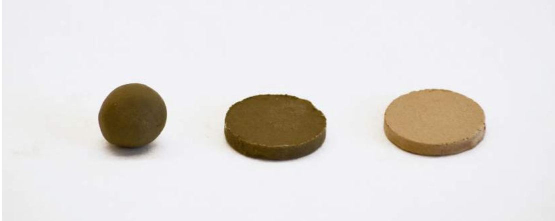
Figur 4.2.1.: Teglpilleproduktionens stadier; blanding, formning og brænding.
