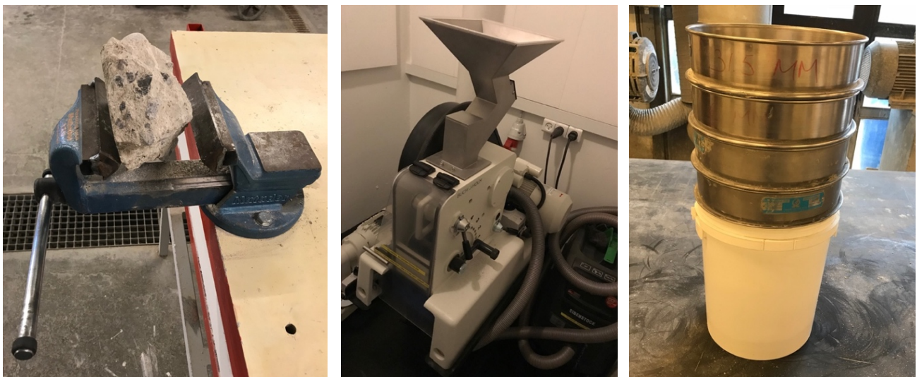
Figur 9 - Venstre: Speciallavet skruetvinge. Midten: Kæbeknuseren. Højre: Manuel sigtesøjle til sortering
