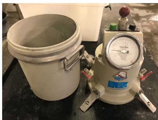
Figur 16 - Apparat til måling af luftindhold i den friske beton
