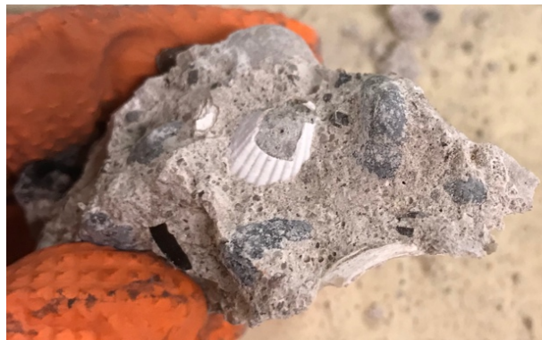
Figur 7 – RCA Betonblok inden knusning indeholdende muslingskal.
