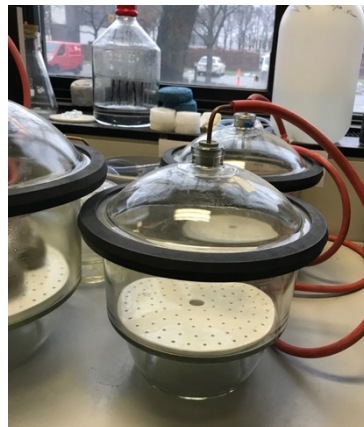
Figur 10 - Eksikator hvori pyknometrene uden låg placeres
