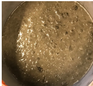
Figur 20 - Komprimering af blandingen RCA50_4-8_8-16, hvor RCA ses søge mod overfladen.
