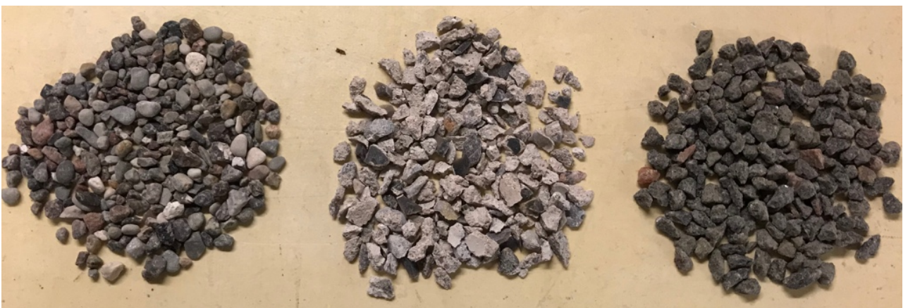
Figur 19 - Stentilslag i 4-8 mm fraktionen. Fra venstre: Søsten, RCA, granitskærver
