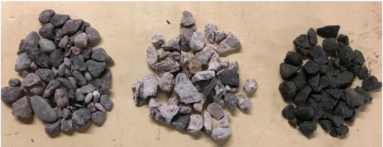
Figur 18 - Stentilslag i 8-16 mm fraktionen. Fra venstre: Søsten, RCA, granitskærver
