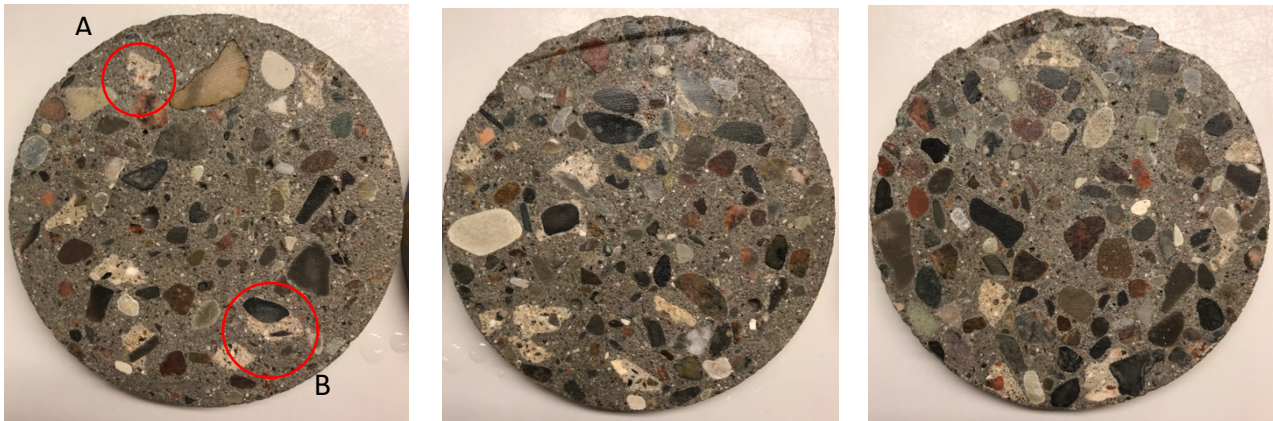
Figur 29 - Tværsnit af prøven RCA15_8-16 fra venstre: Top, midt og bund. Eksempel på udseendet af RCA markeret med rød cirkel, hvor A viser RCA kun bestående af cement og sand, mens B viser RCA som en sten med AM.
