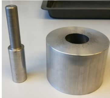
Figur 12 - Sandkegleform (Cylinder udført som kegle indvendigt)
