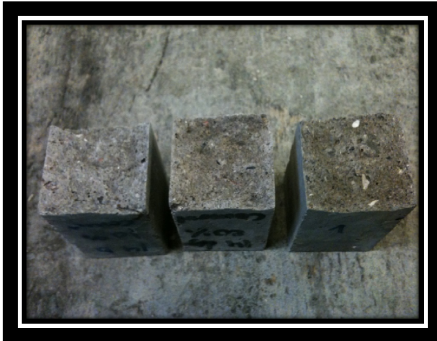
Figur 5 - (2012. Tværsnit af mørtelprøver efter styrketest. DTU 119)
