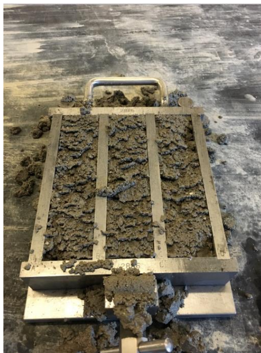
Billede 2 - Eksempel på blandingsrecepten på 10 % cementerstatning uden tilsat vand
