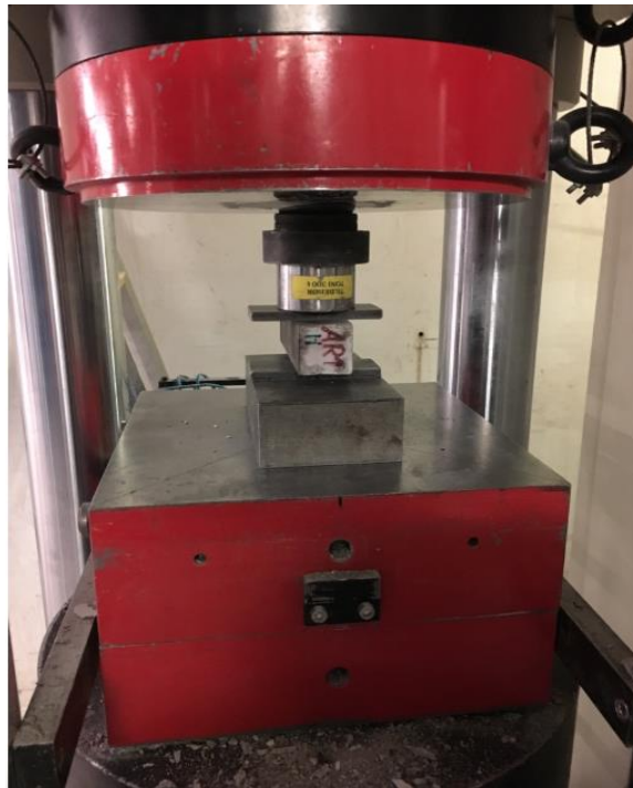
Billede 3 - Trykstyrke test i trykstyrkemaskine
