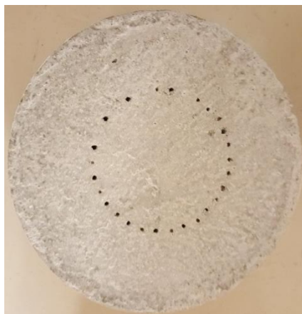
Figur 8 – Nål penetreringsmønster i prøven.
