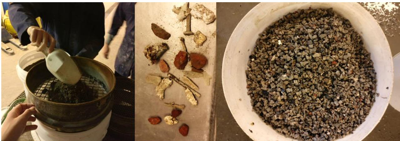
Figur 4 - Til venstre ses sigtning af aggregater i metalmaske. Midt er søm, ekspanderet polystyren, glas og tegl. Til højre ses de skyllede genbrugsaggregater i størrelsen 4 \leq 8 mm.
