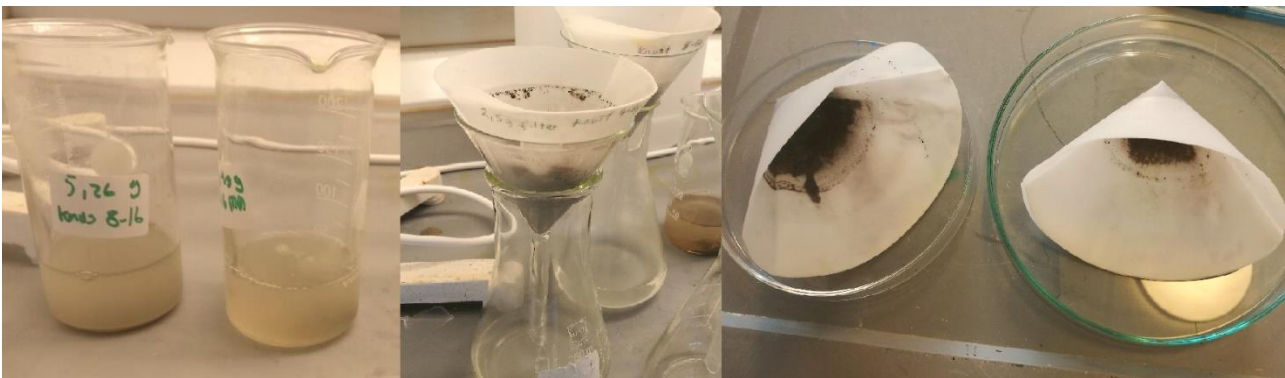
Figur 8: Til venstre: Bægerglas med salpetersyre, \text{HNO}_3 og betonpulver. Midtfor: Filtrering i kolbe. Til højre: Filter i petriskål.
