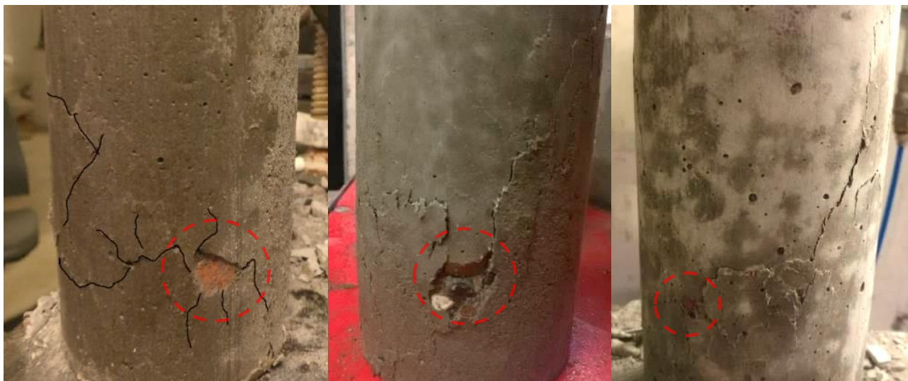
Figur 22: Brudfigurer fra trykstyrketest. Teglstykker markeret med rød ring i brudlinjerne på brudfigurer.
