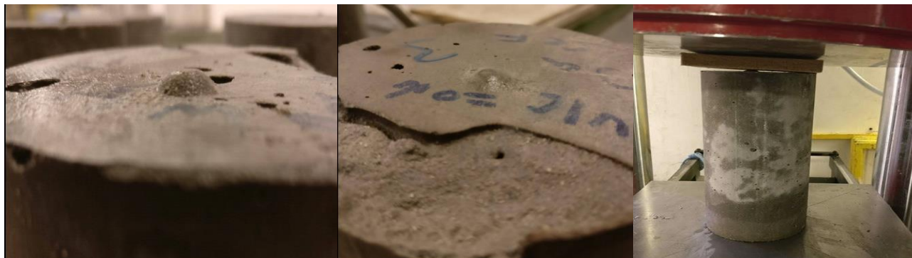
Figur 19: Tv og midt: Nærbillede af topbetoncylindere støbt med ujævnheder i overfladen. Th: Betoncylindre med træplade for at kompensere ujævnheder i overflade.
