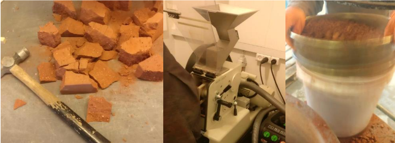
Figur 9: Knusning og sigtning af tegl.
