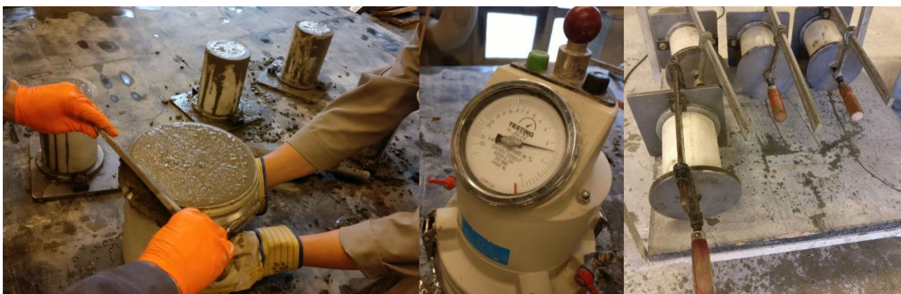
Figur 15 - Til venstre: toppene skæres af beholder og forme. Midtr: måling af luftindhold i beton. Højre: opbevaring af cylinderne.
