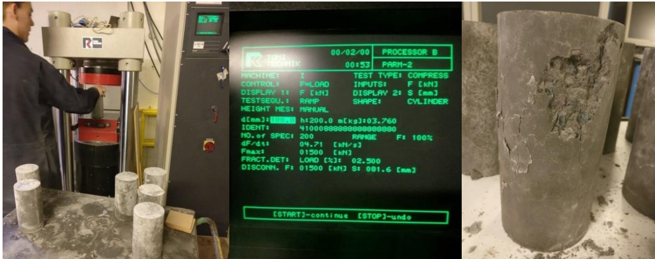
Figur 16 - Tv: Cylinder anbringes i trykmaskinen. Midt: vægt, højde, diameter og trykhastighed indtastes på displayet. Th: Brudfigur noteres.
