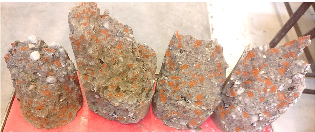
Figur 29: Beton med tegl efter trykprøvning.
