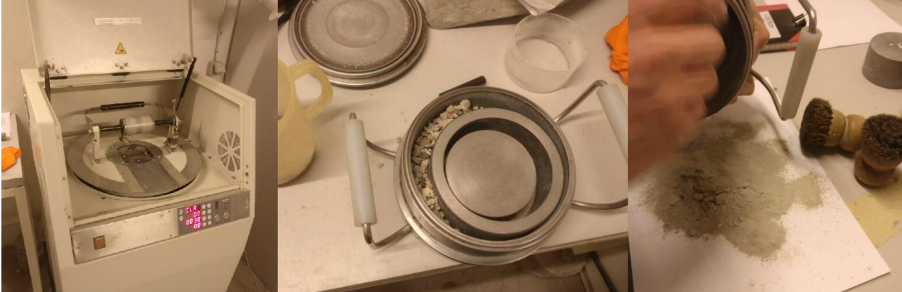
Figur 7: Til venstre ses ringknusermaskinen. Midtfor er metalskål med metalringe og aggregater som indsættes i ringknuseren. Til højre ses ringknuseren som pulveriseres genbrugsaggregaterne.
