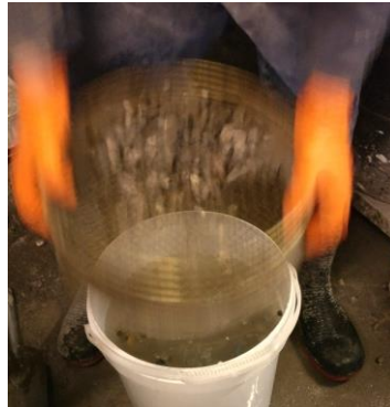
Figur 13 - Rystning af vandmættede genbrugsaggregater for at få overskydende vand væk.
