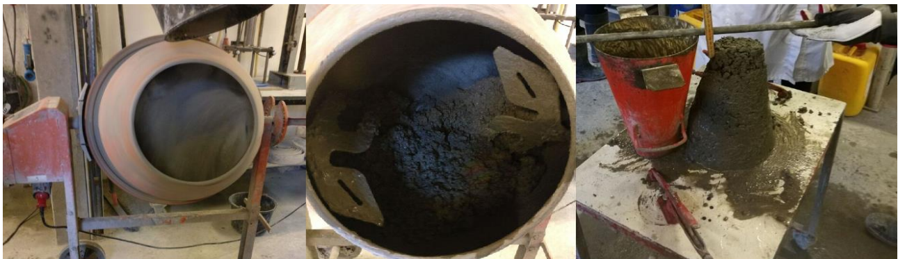
Figur 14 - Til venstre blandes tilslaget med cementen i mixer. Midtfor ses den våde beton. Til højre er slumtest udført med ny beton.
