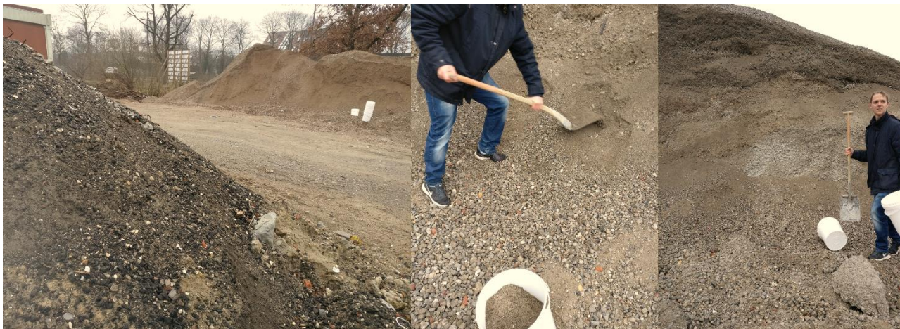
Figur 3 - Til venstre ses to dynger af genbrugsaggregater. Til højre og midtfor ses indsamling af betonaggregater i hvide spande.
