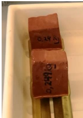
Figur 10: Teglsten i vandbakke med destilleret vand.
