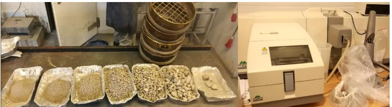
Figur 6: Tv: Genbrugsaggregater delt op i hver størrelse. Th: Laseranalyse i laboratorium.
