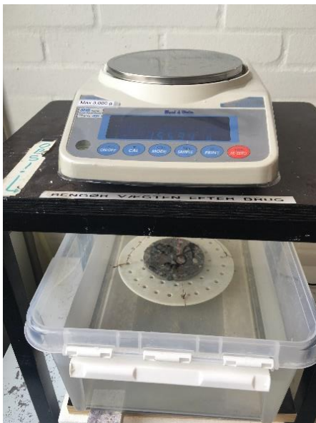
Figur 29. Vejning under vand
