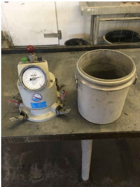
Figur 21. trykmeteret uden låg er monteret
