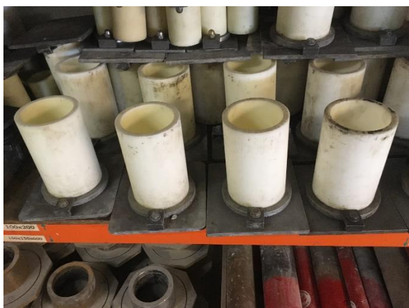
Figur 23. Forme til støbning af cylindrerne
