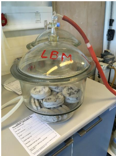
Figur 27. Eksikator tilsluttet vakuumpumpe med prøvelegemer i.
