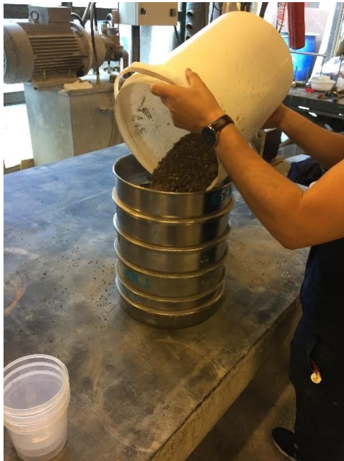
Figur 11. Sigtning af kornfraktionen igennem alle sigterne
