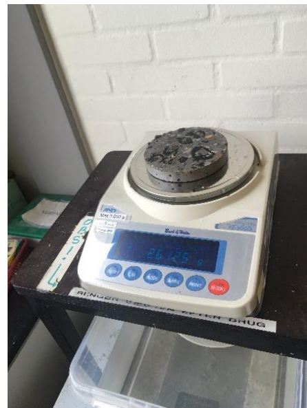
Figur 30. Vejning over vand med overfladetør vandmættet tilstand.
