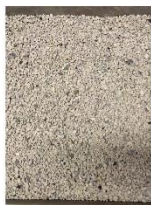
Billed 1: Nedknust beton, som er tørret ved 50 grader i 4 dage.
