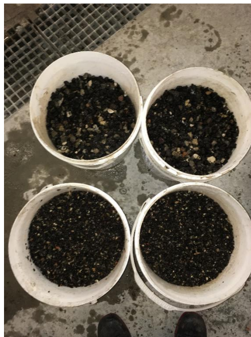
Figur 5. Sorteret tilslag med 4-8 mm og 8-16 mm sten
