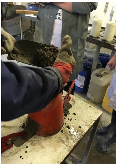
Figur 18. keglen fyldes 1/3 med beton.
