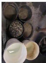
Billed 2: Opvejet materialer som benyttes i betonblandingen.
