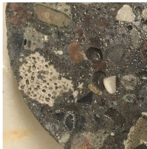
Figur 26. Et betonaggregat, hvor porøsiteten kan ses
