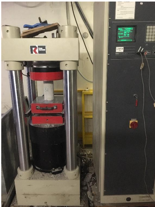
Figur 31. Toni 3000 med belastning af cylinder
