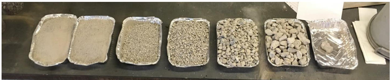
Figur 12. En fordeling med kornstørrelserne efter sigtning
