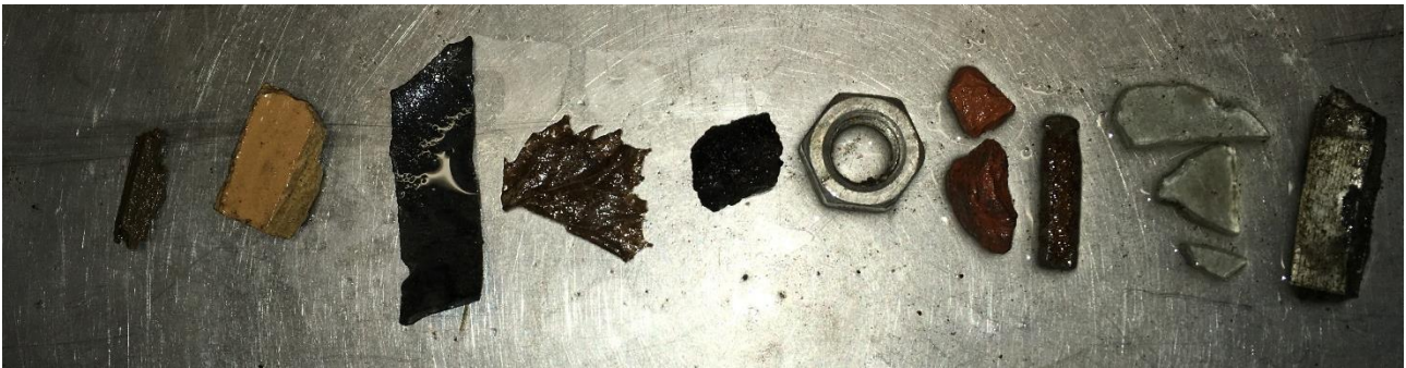
Figur 6. Urenheder fra sigtningen. Der er glas, tegl, plastik, blade og metal
