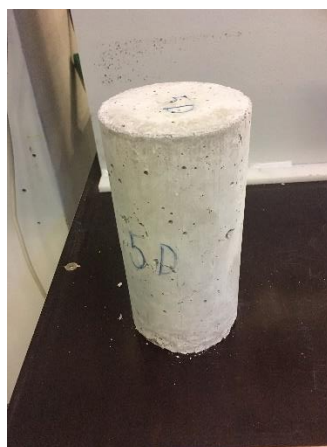
Figur 24. Færdigstøbt cylinder på 100x200 mm
