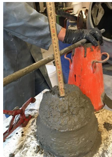
Figur 20. Keglen fjernes, hvorefter sætmålet noteres.
