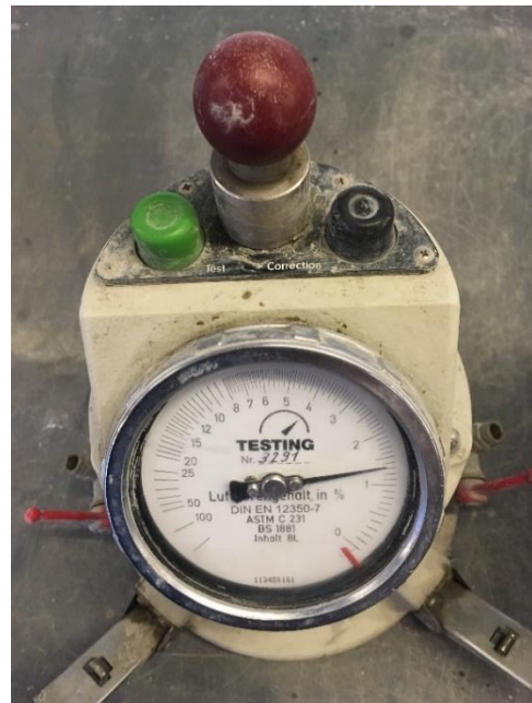
Figur 22. Trykmeter hvor den grønne knap er for kalibrering og den sorte er for det endelige luf indhold
