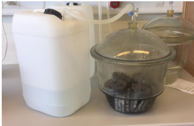
Figur 14 - Opfyldning af destilleret vand i vakuum
