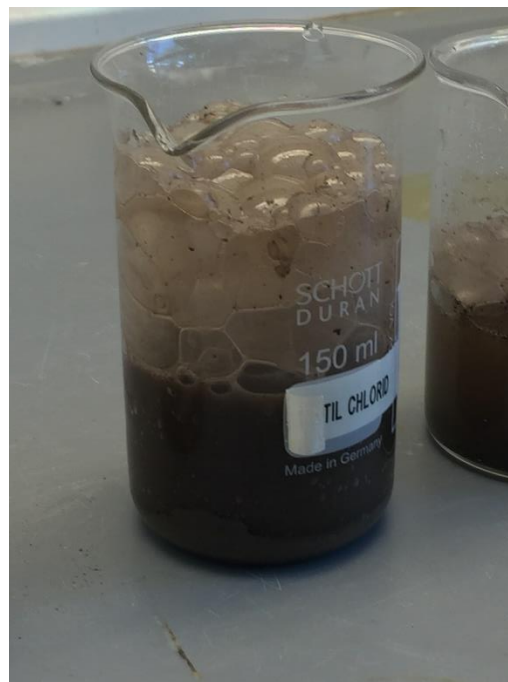
Figur 7 - Store pulver tilslag under salpetersyre
