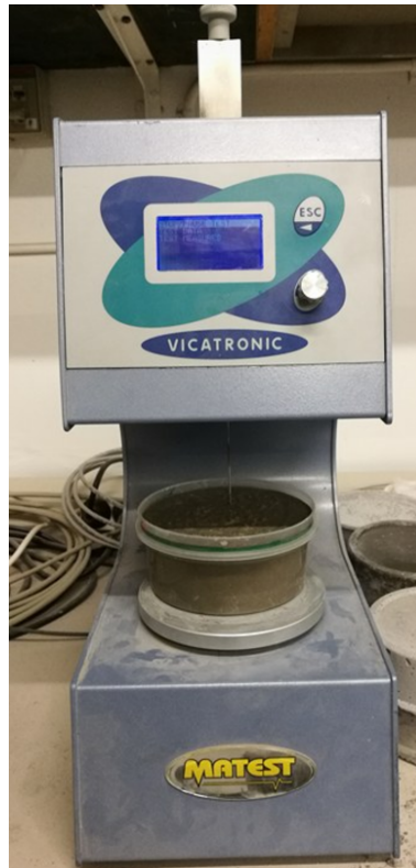
Figur 6.9: Figuren viser apparatet vicatronic, som bruges til at bestemme afbindingstiden.
