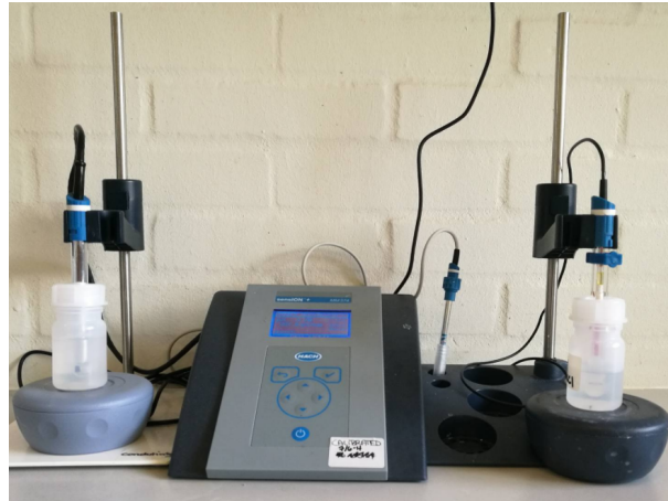
Figur 6.1: Figuren viser sensION MM374, som bruges til at bestemme pH-værdien.
