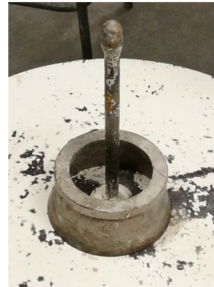
Figur 6.8: Figuren viser tamperen og formen, hvis indvendige diameter er 50 mm i toppen, hvor den ifølge standarden skal være 70 mm.
