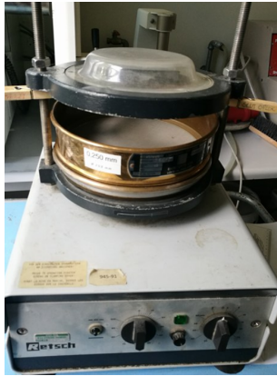
Figur 6.3: Figuren viser sien, som eftertjekker kornenes størrelse, der bliver rystet af det viste apparat.
