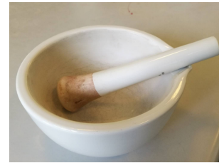
Figur 6.4: Knusningen af tailingen foregik med den viste mortar.
