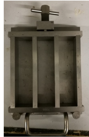
Figur 6.6: Figuren viser støbeformen, som har målene 40 x 40 x 160 mm.
