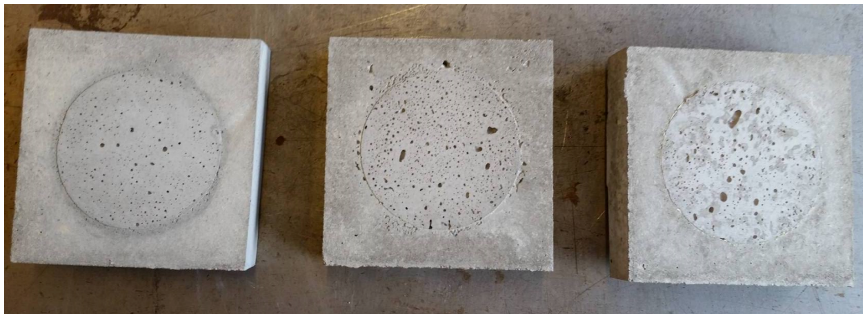
Figur 7.5: Figur med sammenligning af de tre farveprøver. Fra venstre REF, Z-10% og M-10%. REF og Z-10% er støbt af Nina Marie Sigvardsen.
