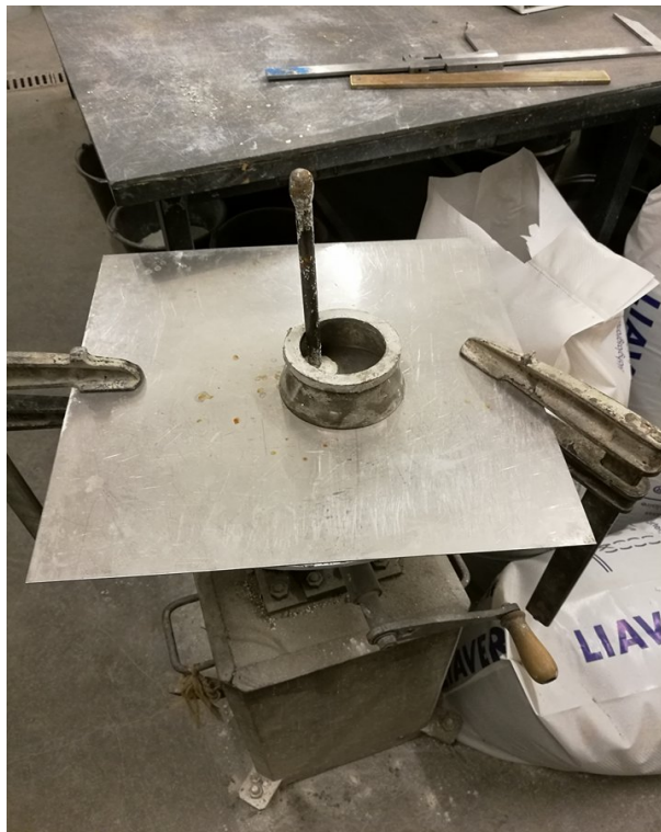
Figur 6.7: Billede af flydebordet, med den benyttede form samt tamper. Foto af Niklas Ørum, s143857
