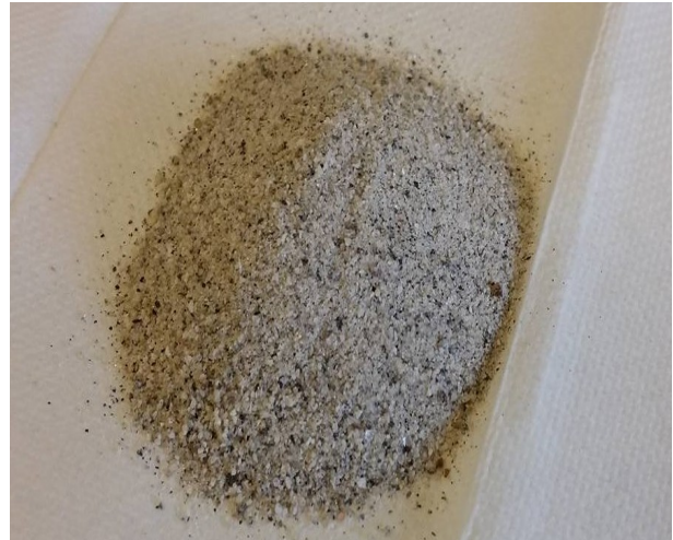
Figur 5.2: Mätäsvaara mine tailing
