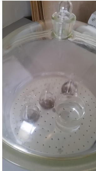
Figur 11: Pyknometerglas og et bægerglas med vand i vakuum.
