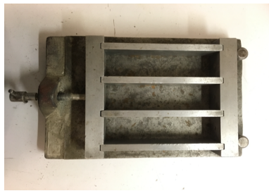
(a) Støbeform til mørtelprismer
