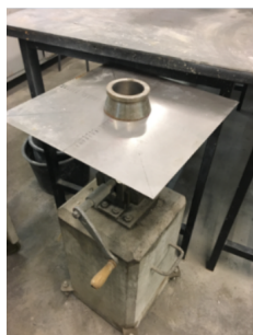
(a) Rystebord til flydesætmål (b) Værktøjer til flydesætmål
