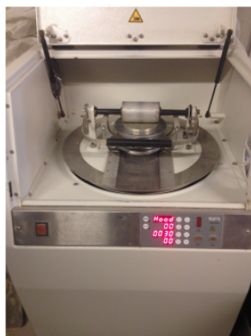
Figur 3.1: Ringknuser. Billede jf. Bonnerup og Sigvardsen [2014]
