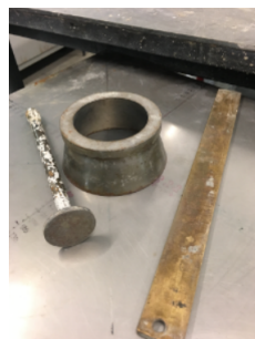
(a) Rystebord til flydesætmål (b) Værktøjer til flydesætmål
