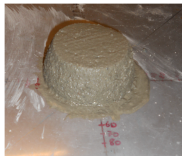
(a) Måleretninger for flydesætmål (b) Flydesætmål for en mørtelblanding
