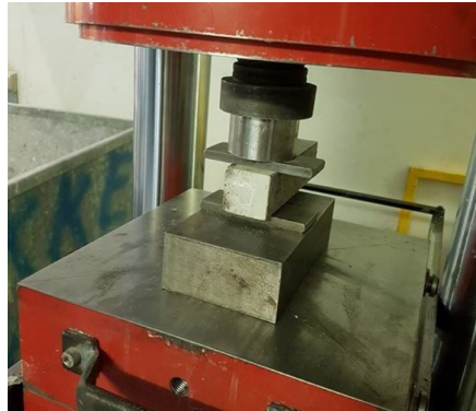
Figur 3.9: Forsøgsopstilling til tryktest.
