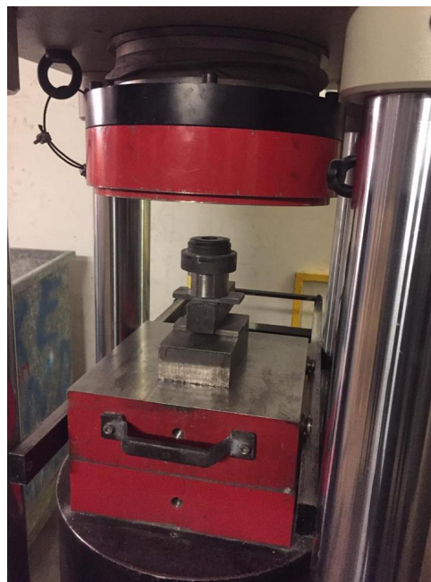
Figur 3.5: Forsøgsopstilling i Toni 3000 til bestemmelse af trykstyrke
