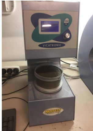
Figur 3.3: Forsøgsopstilling til bestemmelse af afbindingstid med Vicatronicapparatet
